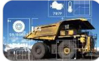
Датчики сбора данных установлены на различных узлах техники (двигатели, шины, ведущий мост) для мониторинга ключевых параметров (температура, вибрация, давление в шинах)
