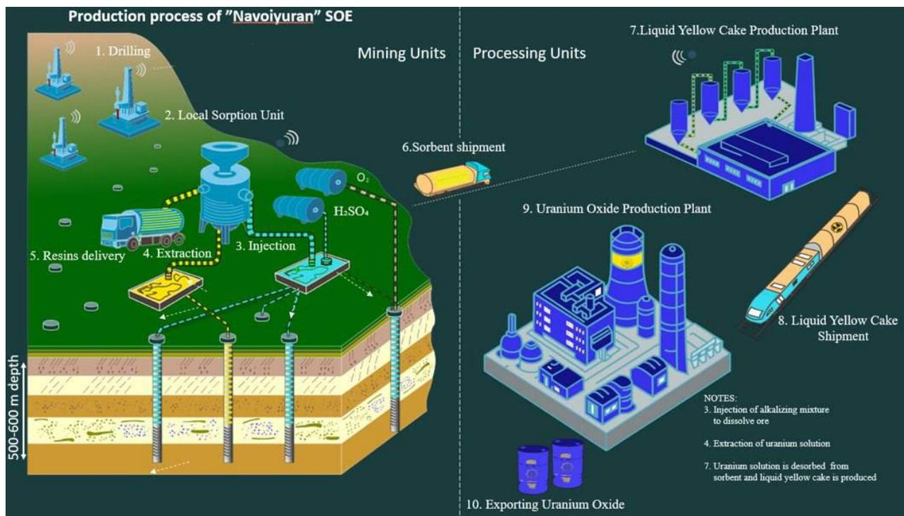
ГП «Навоийуран» один из ведущих производителей урана в Центральной Азии. Предприятие осуществляет добычу и переработку урановой руды с использованием современных технологий. Основным методом добычи урана на ГП «Навоийуран» является подземное скважинное выщелачивание (ПВ) — современная технология, позволяющая извлекать уран из недр без подъема горной массы на поверхность. Производственный цикл охватывает весь технологический процесс — от геологоразведки до получения готовой экспортной продукции.
